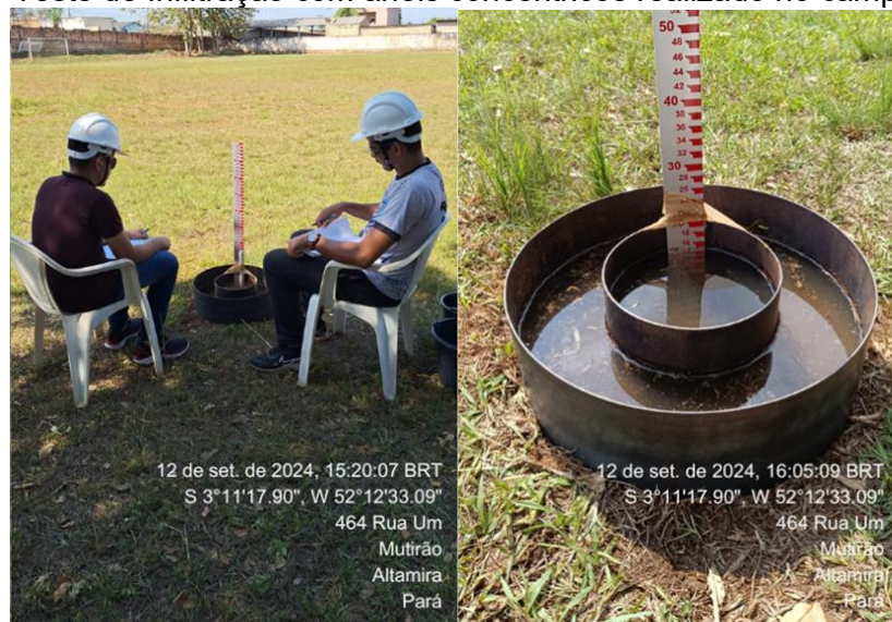
Figura 03 - Teste de Infiltração com anéis concêntricos realizado no campus da UEPA
