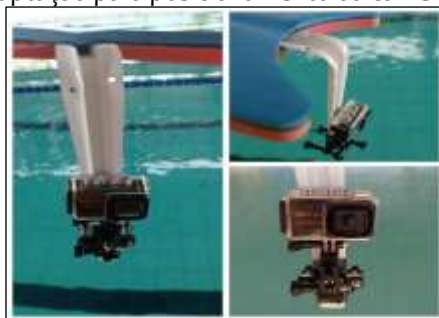
Figura 1 – Adaptação para posicionamento da câmera subaquática
